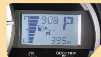
New Multi Information Display (R, R Sporty) Fitur digital yang memiliki 6 fungsi: • Average (konsumsi rata-rata bahan bakar) • Range (jarak tempuh dengan sisa bahan bakar) • Trip (jarak satu tempat ke tempat lain) • Odo (jarak tempuh keseluruhan) • Fuelbar (status bahan bakar) • Clock (menunjukkan waktu)
