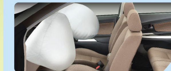
Dual SRS Airbag Mengurangi potensi cedera pada pengemudi dan penumpang depan saat terjadi tabrakan frontal
