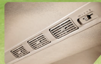
AC Double Blower (M, M Dlx, X, X Dlx, R, R Sporty) Membuat kabin lebih dingin sampai baris ketiga
